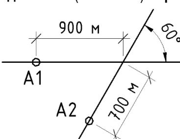
Два автомобиля (A1 и A2) подъезжают к перекрёстку дорог по углом 60°. В некоторый момент времени автомобили находились на расстоянии от перекрёстка показанном на рисунке. Скорости автомобилей постоянны и равны 36 км/ч и 72 км/ч соответственно. Какое кратчайшее расстояние будет между автомобилями и через какое время они на этом расстоянии окажутся?
