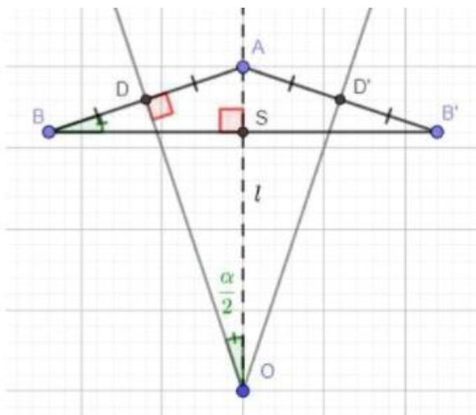
Изображение  $B$  и  $B'$  находятся на таком же расстоянии от поверхности зеркал, что и предмет  $A$ :  $BD = B'D' = DA = D'A$ , значит  $\triangle ABB'$  - равнобедренный.
